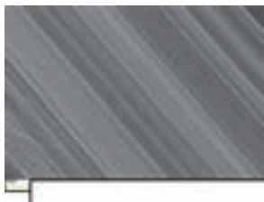
Fig. 1. En svepelektronmikroskopbild av en svarvad (maskinbearbetad) yta. Spår lämnade av det skärande instrumentet är tydligt synliga.
