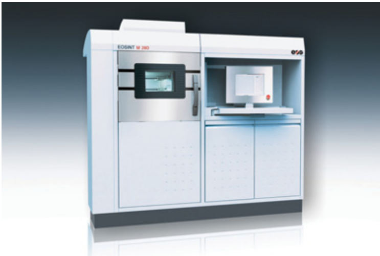
Fig. 2. I lasersintringsmaskinen sintras den protetiska konstruktionen enligt den digitala CAD-ritningen (foto: EOS GmbH).
