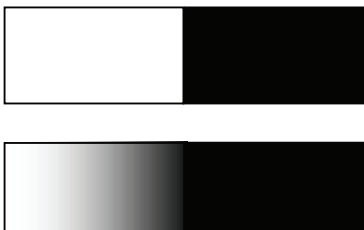
Figur 8. Framställd bild som symboliserar blooming, energin svämmas över till omgivande pixlar.
